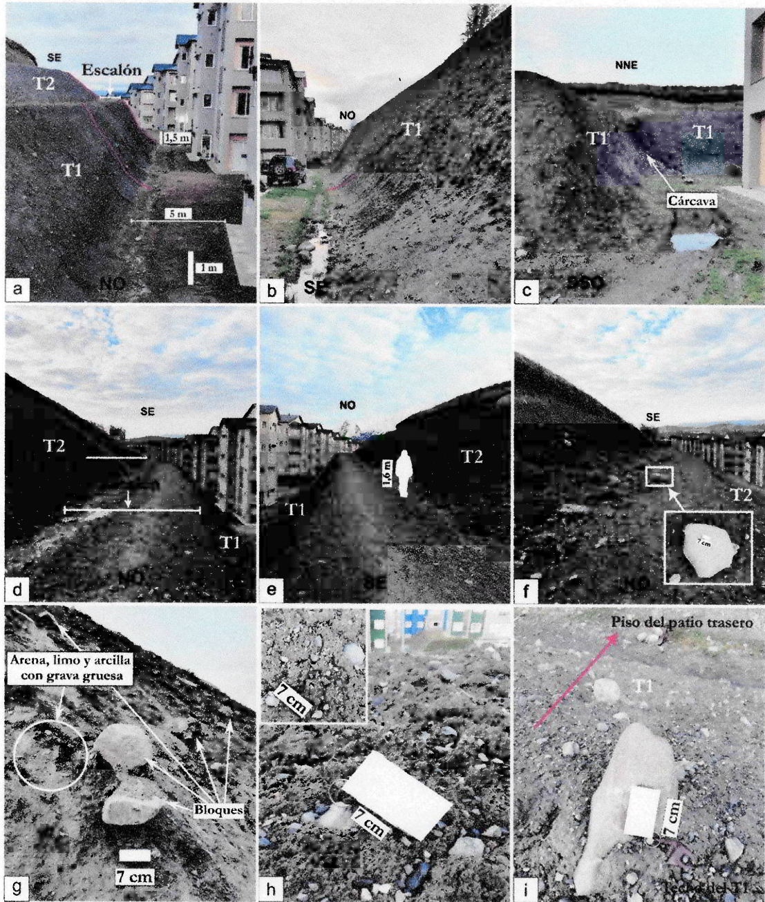
Figura 2: (a) Vista hacia el sudeste de los taludes T1 y T2, la flexura de las líneas rojas muestra el cambio de pendiente; los puntos blancos que se observan sobre la superficie del talud corresponden a bloques de diferentes tamaños. (b) Vista hacia el noroeste del T1. (c) Vista del sector donde el talud T1 presenta un quiebre hacia el SSO, en el lateral del edificio de Quinquela Martin 1775, además, se observa una zona de drenaje de agua donde se ha desarrollado una cárcava. (d) y (e) Vista del T2 y del escalón hacia ambos lados de su extensión. (g) vista en detalle de los diferentes tamaños de grano que componen el sedimento del T1. (h) Detalle de la segregación de grava debido al proceso de congelamiento y descongelamiento. (i) Bloque situado en el borde del techo del T1 (escalón), un tercio de este bloque se encuentra suspendido en el aire (la flecha roja indica la ladera descendente del T1).
